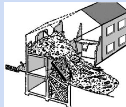
Завали навколо будівлі
